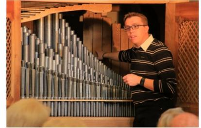
La colonne d'air se déplace dans les différents tuyaux par un jeu de tringleries. Le plus gros des tuyaux mesure 2.7 m.
